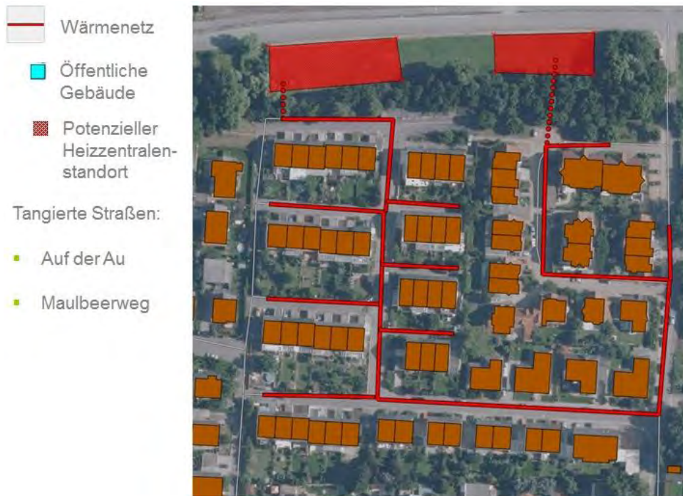
Abb. 17-15: Wärmernetz 4 - Auf der Au
