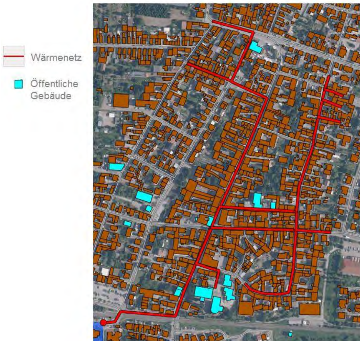
Abb. 17-17: Wärmenetz 6 - Dorf Kern
